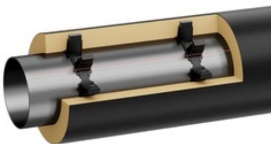
Теплоизолированная труба с защитным слоем из полиэтилена высокой плотности. Марка стали – ст 10–ст 20. Предназначена для применения в магистральных и внутриквартальных сетях трубопроводов отопления и водоснабжения.
