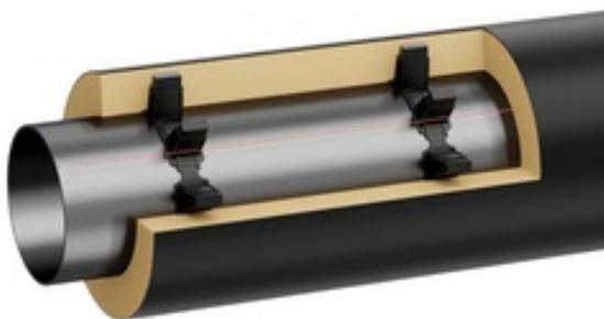
Теплоизолированная труба с защитным слоем из полиэтилена высокой плотности. Марка стали – ст 10–ст 20. Предназначена для применения в магистральных и внутриквартирных сетях трубопроводов отопления и водоснабжения.
