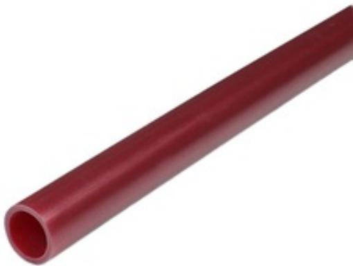
Многослойная труба на основе термостойкого полиэтилена РЕ-РТ тип I с ЕВОН слоем, который препятствует проникновению кислорода. Применяется в системе тёплого пола.
