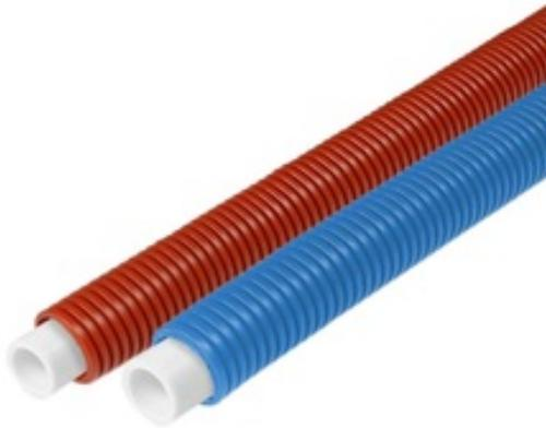
Однослойная труба на основе термостойкого полиэтилена PE-RT тип II в защитном гофрированном кожухе. Применяется для скрытой прокладки горизонтальных систем ГВС, ХВС и отопления.
