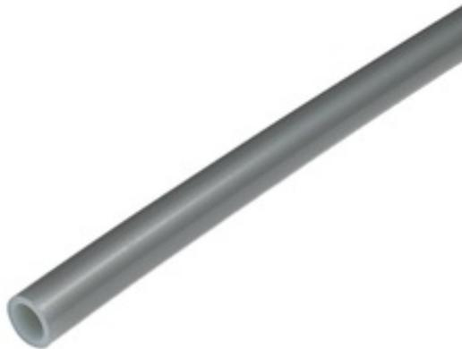
Многослойная труба на основе сшитого полиэтилена РЕ-Ха с EVOH слоем, который препятствует проникновению кислорода. Применяется в системе ГВС и отопления с лучевой разводкой для подключения радиаторов.
