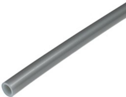
Многослойная труба на основе сшитого полиэтилена PE-Ха с EVOH слоем, который препятствует проникновению кислорода. Применяется в системе ГВС и отопления с лучевой разводкой для подключения радиаторов.
