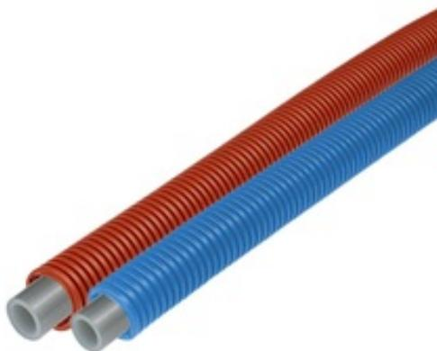
Многослойная труба на основе сшитого полиэтилена PE-Xa с EVOH слоем в защитном гофрированном кожухе. Применяется в системе ГВС и отопления с лучевой разводкой для подключения радиаторов.
