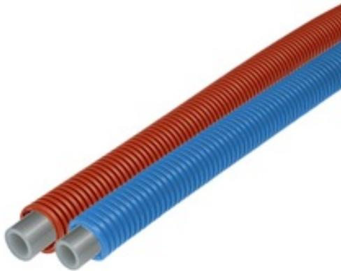
Многослойная труба на основе сшитого полиэтилена PE-Ха с EVON слоем в защитном гофрированном кожухе. Применяется в системе ГВС и отопления с лучевой разводкой для подключения радиаторов.
