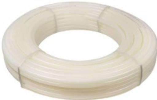
Многослойная труба на основе сшитого полиэтилена PE-Xa с EVOH слоем, который препятствует проникновению кислорода. Рабочее давление – 10 бар. Применяется в системе отопления, водоснабжения и охлаждения.
