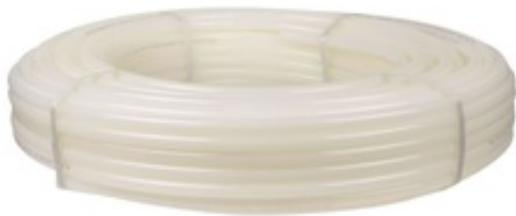
Многослойная труба на основе сшитого полиэтилена PE-Ха с EVOH слоем, который препятствует проникновению кислорода. Рабочее давление – 6 бар. Применяется в системе отопления, водоснабжения и охлаждения.
