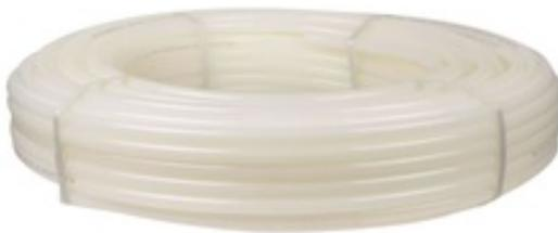
Многослойная труба на основе сшитого полиэтилена PE-Xa с EVOH слоем, который препятствует проникновению кислорода. Рабочее давление – 6 бар. Применяется в системе отопления, водоснабжения и охлаждения.
