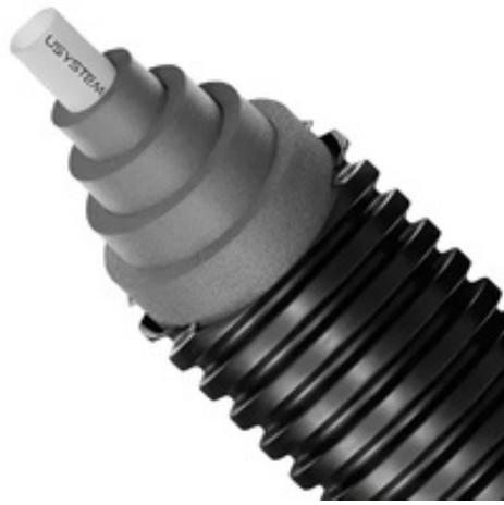
Гибкая теплоизолированная труба на основе сшитого полиэтилена РЕ-Ха с антидиффузионным слоем EVOH в защитном гофрированном кожухе. Одинарное исполнение. Применяется для бесканальной прокладки наружных сетей тепло- холодоснабжения в грунте.
