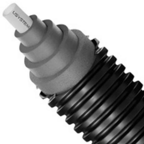
Гибкая теплоизолированная труба на основе сшитого полиэтилена PE-Ха с антидиффузионным слоем EVOH в защитном гофрированном кожухе. Одинарное исполнение. Применяется для бесканальной прокладки наружных сетей тепло-холодоснабжения в грунте.
