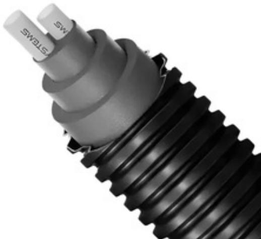
Гибкая теплоизолированная труба на основе сшитого полиэтилена РЕ-Ха с антидиффузионным слоем EVOH в защитном гофрированном кожухе. Двойное исполнение. Применяется для бесканальной прокладки наружных сетей тепло- холодоснабжения в грунте.
