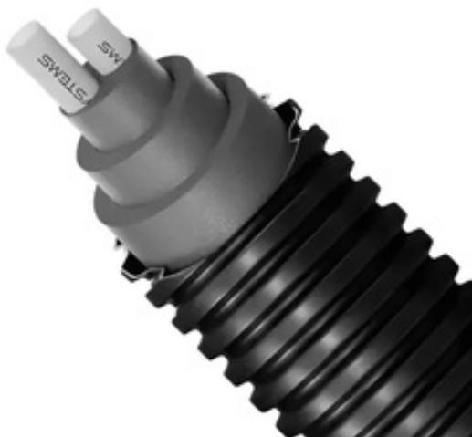
Гибкая теплоизолированная труба на основе свитого полиэтилена PE-Ха с антидиффузионным слоем EVOH в защитном гофрированном кожухе. Двойное исполнение. Применяется для бесканальной прокладки наружных сетей тепло-холодоснабжения в грунте.
