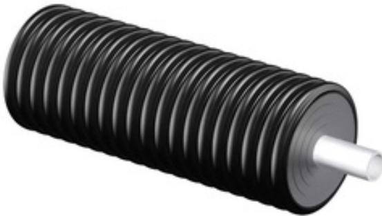
Гибкая теплоизолированная труба на основе сшитого полиэтилена РЕ-Ха с антидиффузионным слоем EVOH в защитном гофрированном кожухе. Одинарное исполнение. Применяется для бесканальной прокладки наружных сетей тепло- холодоснабжения в грунте.
