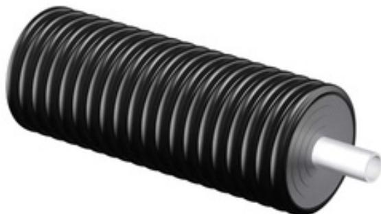
Гибкая теплоизолированная труба на основе сшитого полиэтилена PE-Ха с антидиффузионным слоем EVOH в защитном гофрированном кожухе. Одинарное исполнение. Применяется для бесканальной прокладки наружных сетей тепло-холодоснабжения в грунте.
