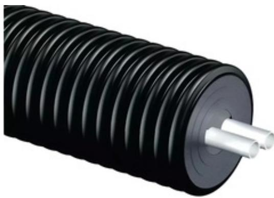
Гибкая теплоизолированная труба на основе сшитого полиэтилена РЕ-Ха с антидиффузионным слоем EVOH в защитном гофрированном кожухе. Двойное исполнение. Применяется для бесканальной прокладки наружных сетей тепло-холодоснабжения в грунте.
