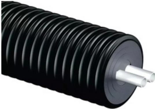
Гибкая теплоизолированная труба на основе сшитого полиэтилена PE-Xa с антидиффузионным слоем EVONH в защитном гофрированном кожухе. Двойное исполнение. Применяется для бесканальной прокладки наружных сетей тепло- холодоснабжения в грунте.
