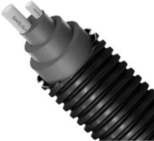
Гибкая теплоизолированная труба на основе сшитого полиэтилена РЕ-Ха в защитном гофрированном кожухе. Двойное исполнение. Применяется для бесканальной прокладки наружных сетей горячего водоснабжения в грунте.
