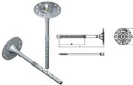
Пластиковый дюбель с тарельчатой шляпкой, в сердцевине металлический стержень с термоголовкой. Упаковка 100 штук. Применяется для крепежа теплоизоляции при штукатурных (мокрых) фасадах.
