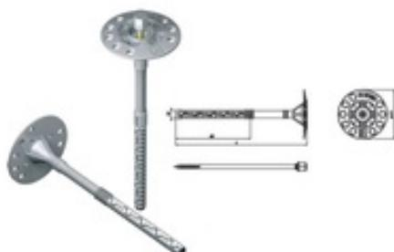
Пластиковый дюbelь с тарельчатой шляпкой, в сердцевине металлический стержень с термоголовкой. Упаковка 100 штук. Применяется для крепежа теплоизоляции при штукатурных (мокрых) фасадах.
