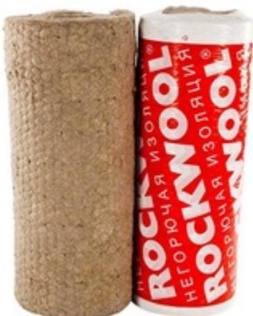
Мат из каменной ваты, прошитый сеткой из гальванизированной или нержавеющей проволоки. Используется для огнезащиты вентиляций и воздуховодов. Промышленные предприятия теплоизолируют оборудование, большие технологические трубопроводы, резервуары, ёмкости.
