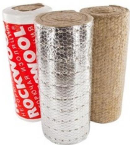
Прошитые маты из каменной ваты с армированной алюминиевой фольгой и с сеткой из гальванизированной проволоки. Строители используют маты для утепления вентиляций и воздуховодов, оборудования, больших технологических трубопроводов, резервуаров, ёмкостей.
