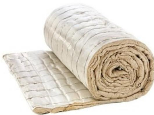
Теплоизоляционный прошивной базальтовый мат без связующего. В обкладке стеклотканью на выбор Т-13, Т-23, Э3-200 с 2x сторон. Используются для теплоизоляции инженерных систем, промышленного оборудования на нефтегазовых объектах, АЭС, ТЭЦ, ГРЭС.
