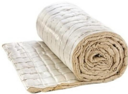
Теплоизоляционный прошивной базальтовый мат без связующего. В обкладке стеклотканью на выбор Т-13, Т-23, Э3-200 с 2х сторон. Используются для теплоизоляции инженерных систем, промышленного оборудования на нефтегазовых объектах, АЭС, ТЭЦ, ГРЭС.
