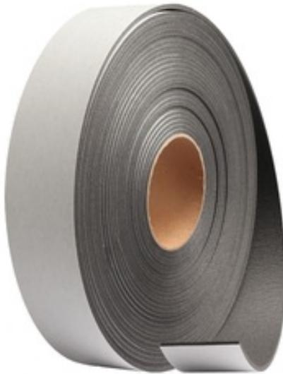
Самоклеящаяся изоляционная лента из вспененного полиэтилена с закрытыми порами. Применяется для соединения элементов покрытий термоизоляции, для покрытия трубных и канальных швов, отделки швов.
