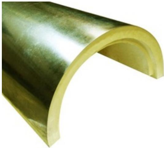
Жёсткая теплоизоляция с продольными и торцевыми тепловыми замками для трубопроводов. Толщина оцинкованного листа 0,55 мм. Используется для трубопроводов на улице.
