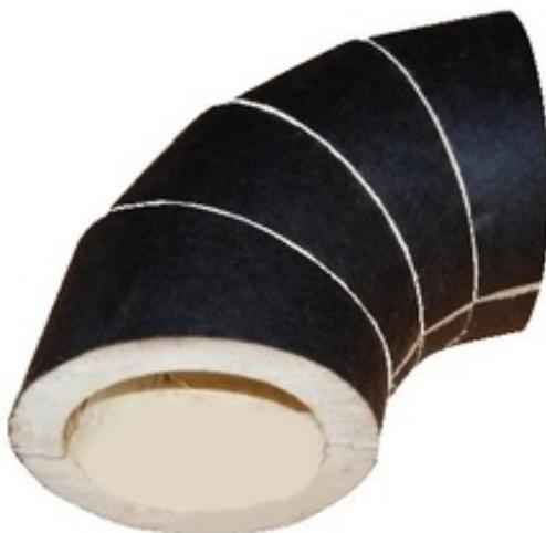
Жёсткая теплоизоляция, плавно изогнутая под углом 90°, с продольными и торцевыми тепловыми замками. Используются для утепления колен трубопроводов.
