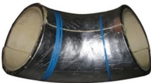
Жёсткая теплоизоляция, плавно изогнутая под углом 90°, с продольными и торцевыми тепловыми замками. Используются для утепления колен трубопроводов.
