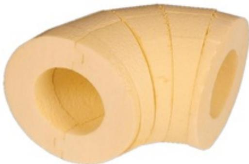
Жёсткая теплоизоляция, плавно изогнутая под углом 90°, с продольными и торцевыми тепловыми замками. Используются для утепления колен трубопроводов.
