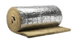
Прошивные теплоизоляционные огнезащитные маты из минеральной ваты со стальной оцинкованной сеткой. Покрыт с одной стороны алюминиевой фольгой. Применяются для тепловой изоляции и огнезащиты резервуаров, оборудования и трубопроводов.
