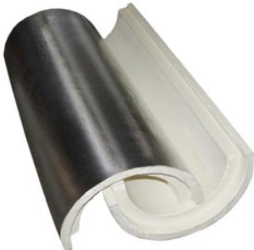
Жёсткие теплоизоляционные сегменты с продольными и торцевыми тепловыми замками. Толщина оцинкованного листа 0,55 мм. Используются для утепления стыков труб.
