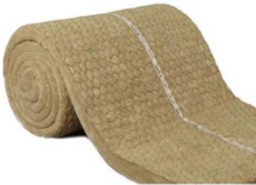
Негорючие прошивные огнезащитные маты на основе базальтового волокна. С одной стороны прошиты стальной оцинкованной сеткой. Используется для утепления и огнезащиты резервуаров и оборудования.
