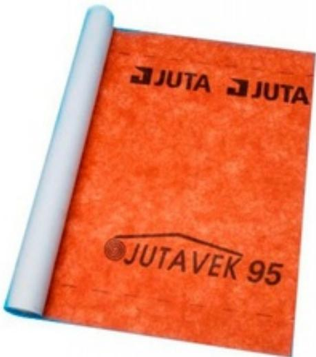
Трёхслойный материал из двух внешних слоёв нетканого полипропиленового текстиля и полипропиленового слоя. Используется для ветрозащиты вентилируемых фасадов, при внешнем утеплении вертикальных стен объектов, для защиты от пыли, копоти и ветра.
