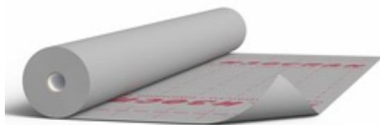
Двухслойный материал из полипропиленового нетканого полотна и полипропиленовой плёнки. Применяется для защиты утеплителя строительных конструкций от проникновения паров воды изнутри помещения.
