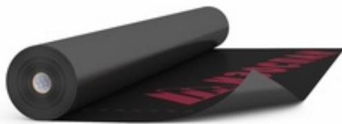
Двухслойный материал из полипропиленового нетканого полотна и полипропиленовой плёнки. Применяется для защиты деревянных элементов конструкции и чердачного перекрытия от атмосферной влаги и подкровельного конденсата.
