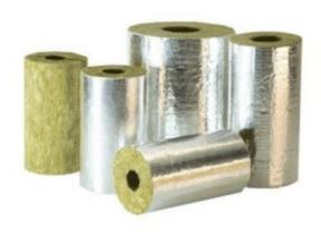
Вырезной теплоизоляционный базальтовый цилиндр с отражающим покрытием. Профессионалы монтируют цилиндры в помещении на трубопроводы систем отопления и водоснабжения. ТУ 23.99.19-012-08621635-2023.
