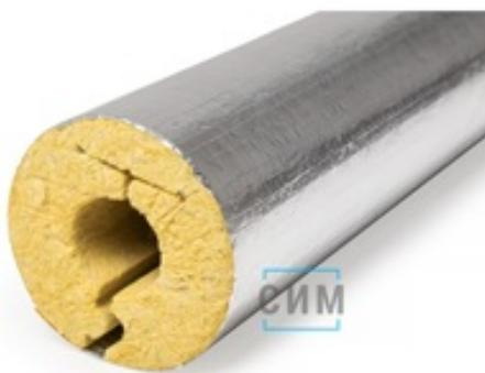
Теплоизоляционные цилиндры из каменной ваты с продольным разрезом «выступ-впадина». Покрытие – алюминиевая фольга армированная стеклосеткой. Востребованы для трубопроводов в помещении и в каналах.
