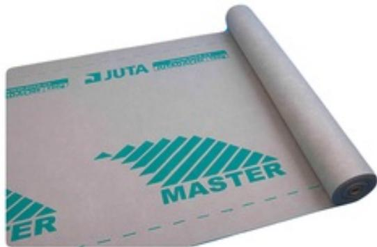
Четырёхслойный материал из внешних слоёв нетканого текстиля, внутренней армирующей сетки, обеспечивающей прочность, и внутреннего слоя, обеспечивающего гидроизоляционные свойства. Используется для защиты конструкций от влаги и ветра.
