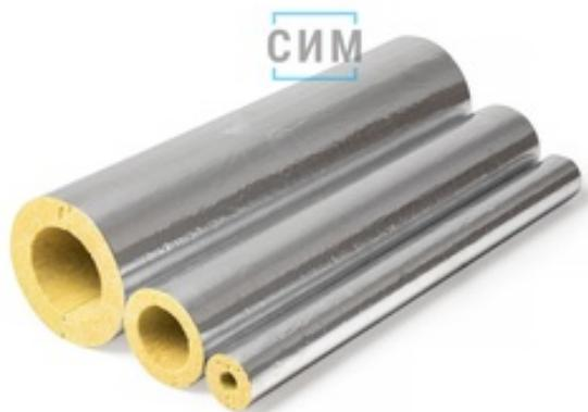
Теплоизоляционные цилиндры из каменной ваты с продольным разрезом «выступ-впадина». Покрытие – фольма-ткань с продольным клеевым нахлестом. Популярны в качестве альтернативы оцинкованному покрытию, монтируют в помещении.
