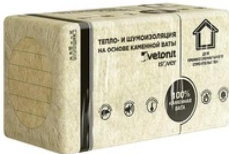
Жёсткая негорючая теплоизоляция из каменной ваты с синтетическим связующим. Используется в конструкциях двухслойного утепления плоской кровли в качестве верхнего слоя.
